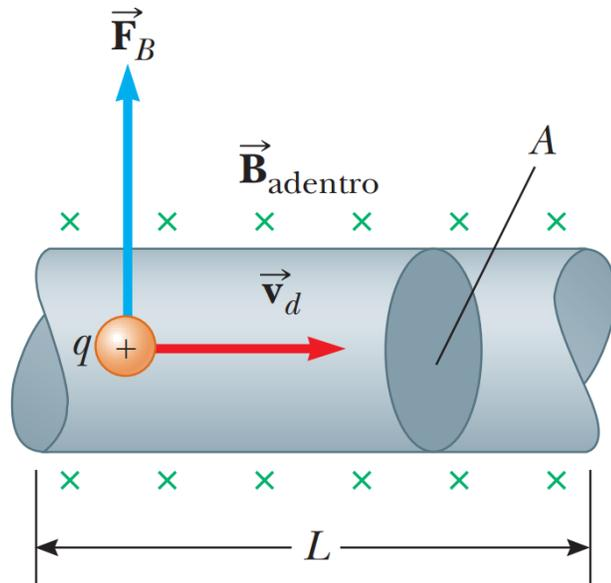
Si cada una de las cargas lleva una velocidad  $\vec{v}_d$ , entonces la fuerza eléctrica sobre una de ellas es  $q\vec{v}_d \times \vec{B}$ .
