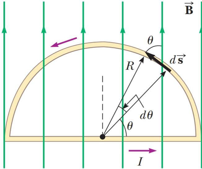
Un alambre conductor doblado formando un semicírculo de radio  $R$  formando un circuito cerrado y transporta una corriente  $I$
