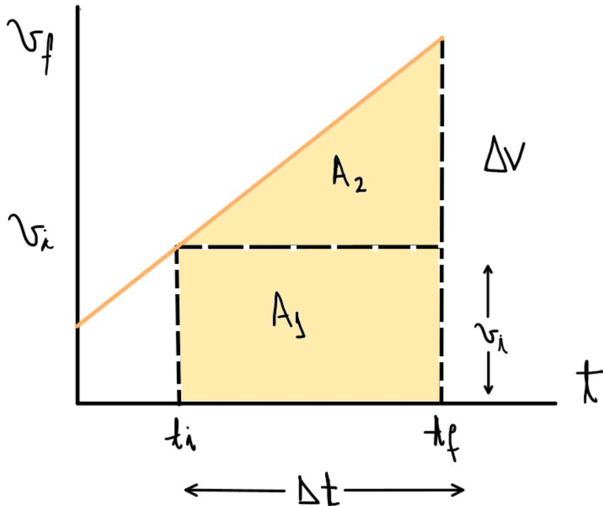
Para calcular el área bajo la curva de velocidad comprendida entre  $t_f$  y  $t_i$ , se divide en dos, por lo tanto, el desplazamiento total de la partícula corresponde a:
