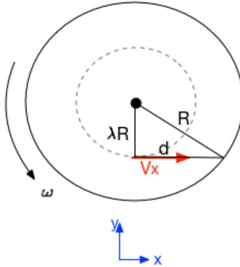
La pulga al saltar con velocidad  $v_0$  perpendicular al plano del disco (en el eje  $\hat{z}$ ) también experimenta una velocidad tangencial  $V_x$  (en el eje  $\hat{x}$ ) de magnitud  $V_x = \omega r$  donde  $r = \lambda R$ . Es decir, la velocidad de la pulga  $\vec{V}_p$  se puede expresar como
