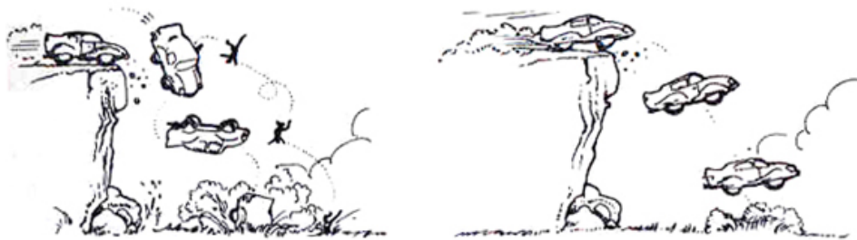
Figura VI.16: La forma como cae un automóvil en un abismo depende de la aceleración que le imprima el conductor en los segundos previos a la caída: si no acelera cae rotando (Figura izquierda), si acelera no rota (Figura derecha).
