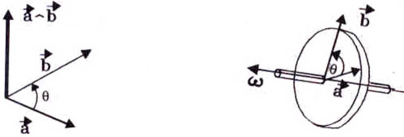
Figura VI.1: Se indica la dirección y sentido del vector que representa el producto vectorial de los vectores \vec{a} y \vec{b} .
