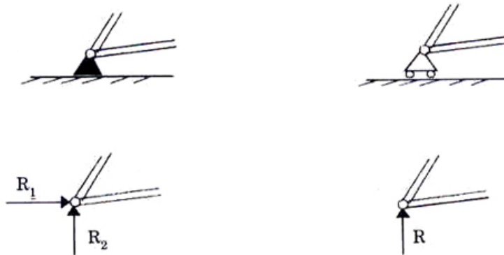
Figura VI.10: Dos tipos de soporte de estructuras: uno fijo al piso y el otro con rodillos que permiten el deslizamiento. Se incluye el diagrama de cuerpo libre de cada uno de ellos.
