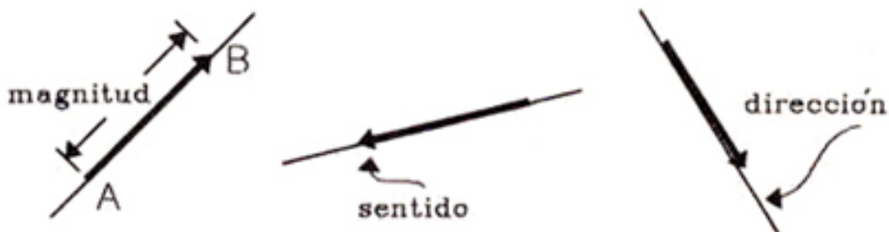
Figura III.2: Representación gráfica de distintos vectores. En cada uno de ellos se indica una de las características de un vector: magnitud, dirección y sentido.
