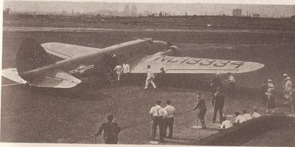
1: Aeroplano moderno, proyectado para disminuir la resistencia al aire y aumentar la potencia de alzamiento, según líneas sugeridas por los estudios de las aves y de los peces. Desde 1920 el desarrollo del conocimiento científico y del diseño técnico han continuado sin cesar en este campo; y con el uso de nuevas aleaciones, como el duraluminio, se han conseguido a la vez ligereza y resistencia. El aeroplano es el culmen de la ingeniería refinada y exacta.
