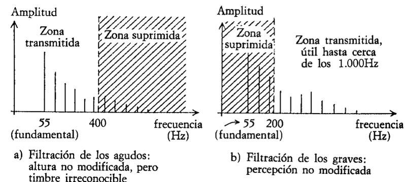
Fig. 14.—Filtración sobre una nota grave (55 Hz)
