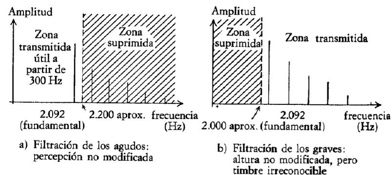
Fig. 15.—Filtro sobre una nota aguda de piano (2.092 Hz)
