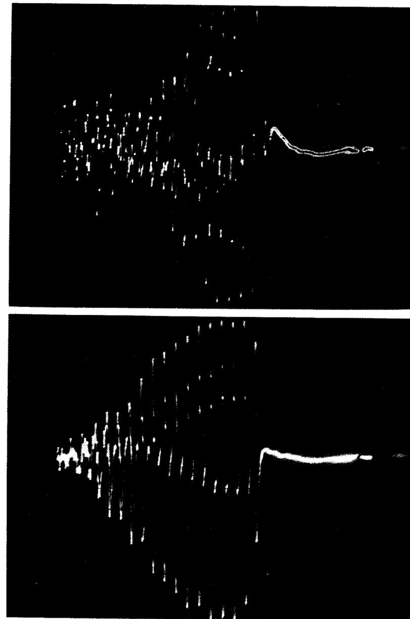
FIG. 4 bis.—Oscilograma de los 50 primeros milisegundos de dos la<sub>1</sub> de violines.
