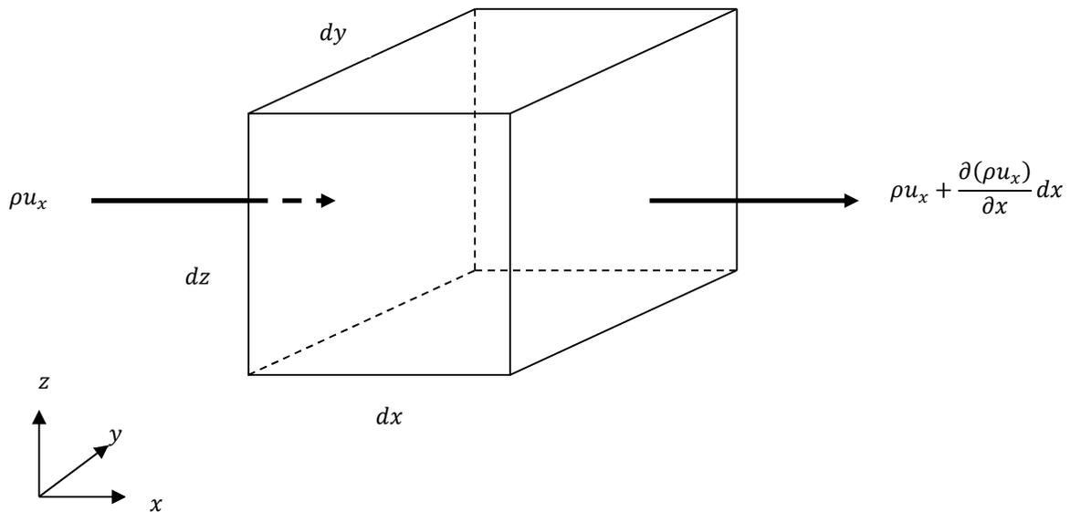
Figura 1.2. Flujo de Masa a través de una partícula de fluido
