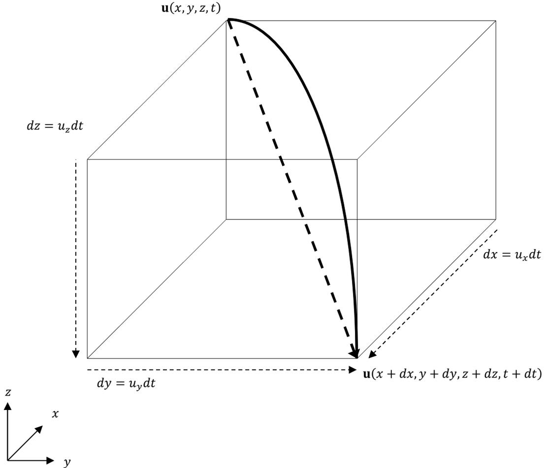
Figura 1.4. Linealización de la trayectoria de la velocidad de partículas
