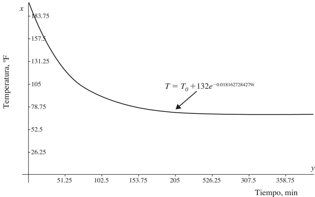
**Fig. 1.12. Gráfica de temperatura contra tiempo para el enfriamiento de un metal.**
