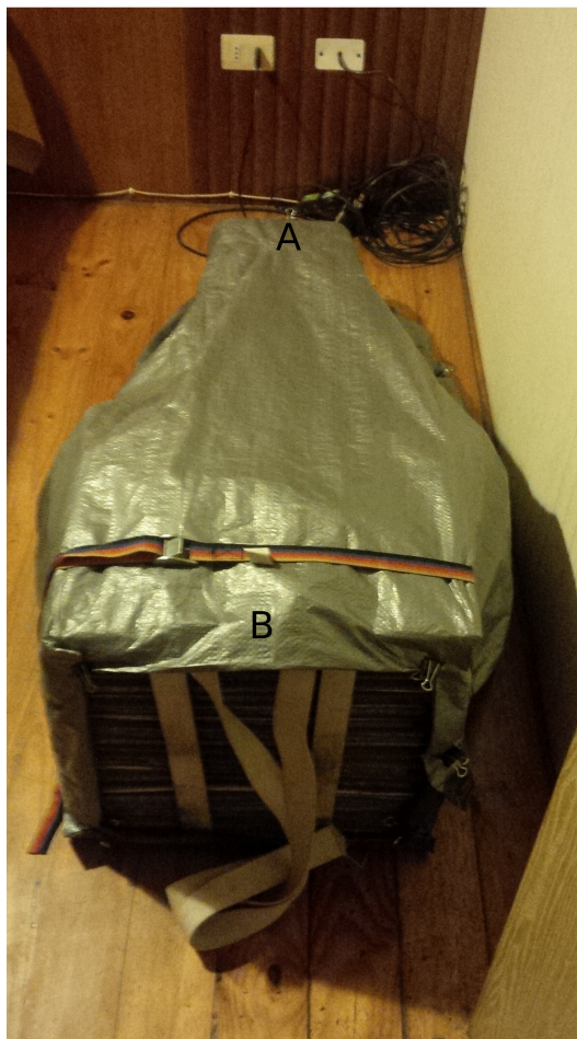
Figura 4: Aspecto de un túnel de sacado en terreno. El calefactor se encuentra en un extremo (A), próximo a una toma de corriente. La prensa con las plantas, los cartones y el metal corrugado se encuentran en el otro extremo (B). El calor se desplaza desde el calefactor a las plantas a través del tunel.
